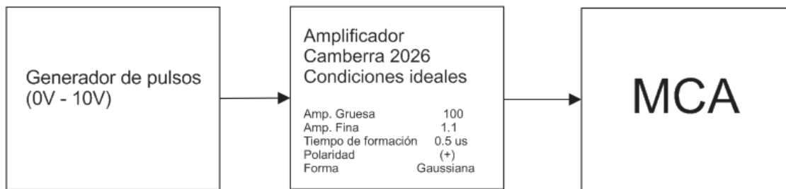
Figura 3.2.3 Diagrama de bloques para la obtención de la relación Potencial vs Canal.
