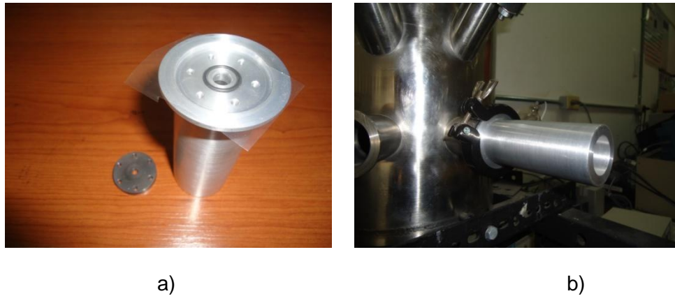
Figura A.1.14 Acoplador II para detector LEGe a) acoplador, con aro sello, hoja de Mylar® y colimador de 5 mm de diámetro b) acoplador ensamblado en la cámara secundaria.
