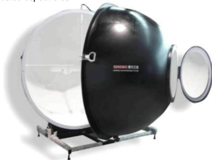
Figura 5.4 Esfera integradora con geometría  $4\pi$  y  $2\pi$
