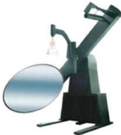
**Figura 3.8** Fotogoniómetro tipo C de espejo móvil Fuente: LMT
