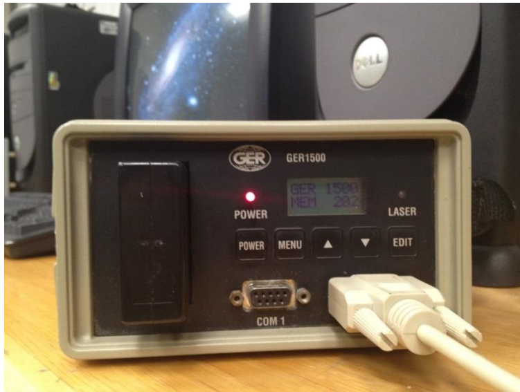
Figura A-4. Conexión serial del espectrómetro.
