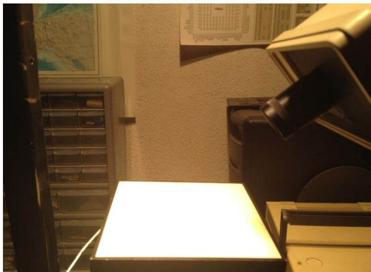
Figura A-3. Apuntamiento y medición sobre el panel Espectralon.
