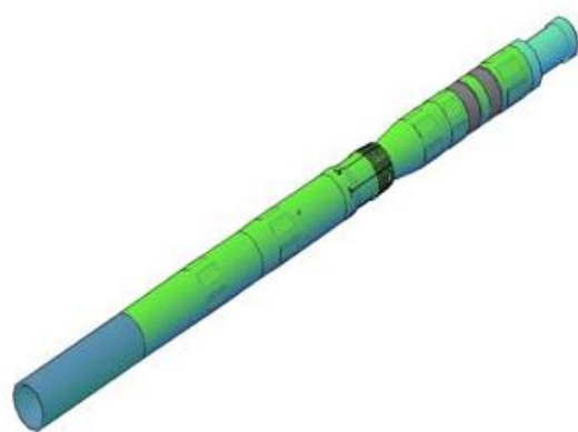
Figura 2. 22. Mejorador de Patrón de Flujo tipo Venturi (MPFV).
