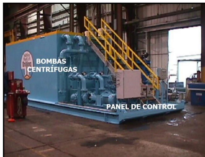
Fig. 2.11 Unidad para filtración de agua de mar
