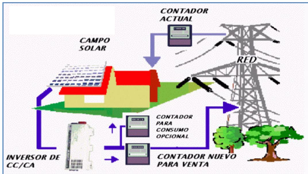
Figura 2.12 Conexión a red. Fuente: Heliostar, 2009
