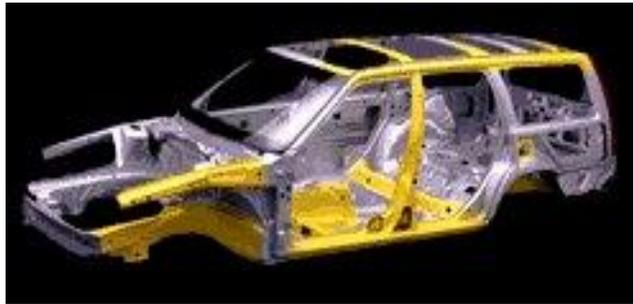
Figura 1.5. Chasis tipo monocasco.
