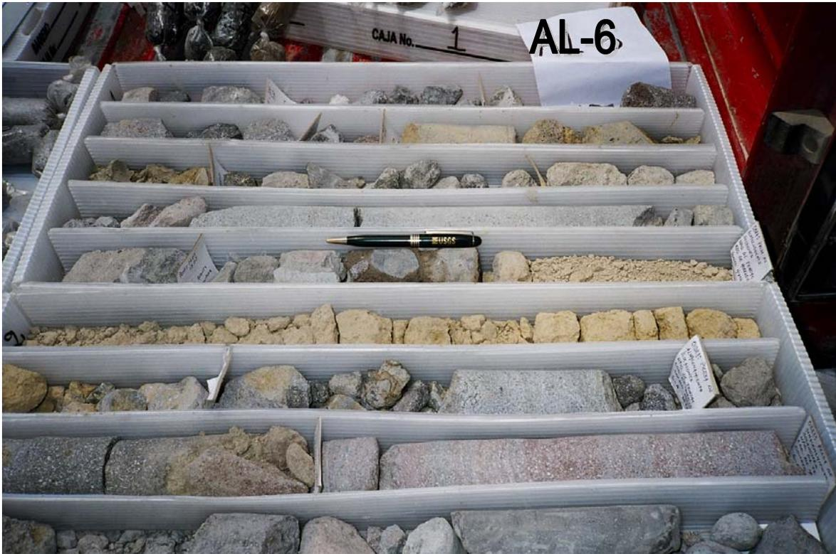
**Fotografía 1. Sondeo (AL-6): el bolígrafo está sobre un núcleo de brecha soldada humedecido. Se aprecia cómo continúan núcleos de la misma brecha soldada, y sobreyacen a un núcleo de la Fm. Tlayécac con mismo material que aflora en las laderas.**
