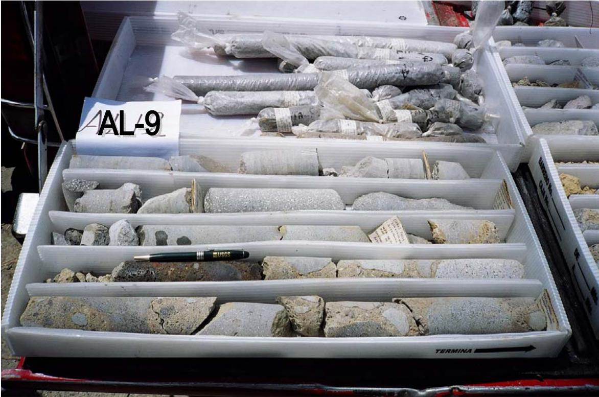
**Fotografía 2. Sondeo AL-9: el bolígrafo está sobre un núcleo de brecha soldada humedecido. Se aprecia cómo continúan núcleos de la misma brecha soldada, y como en el AL-6, continúan núcleos de la Fm. Tlayécac del mismo material que aflora en las laderas.**
