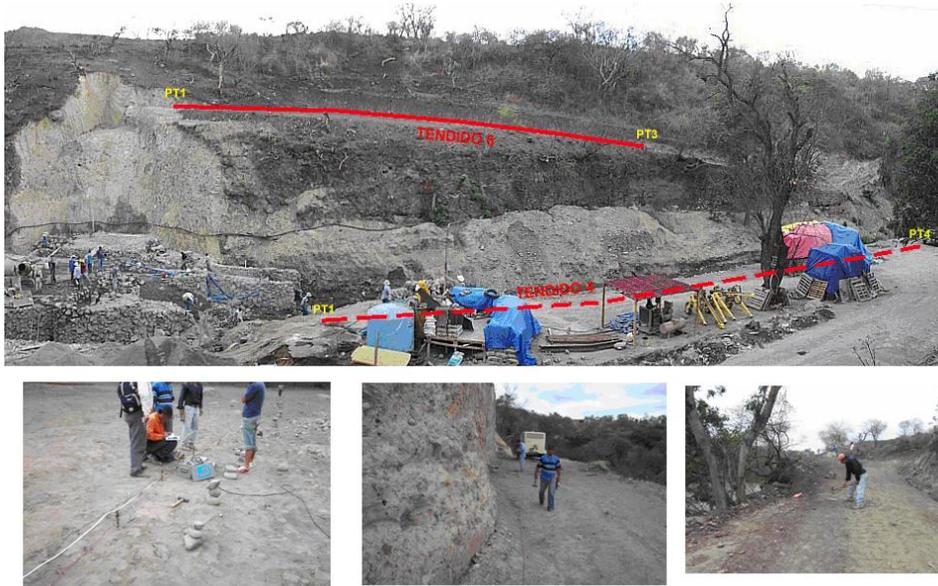
Fotografía 4. Medición de propiedades mecánicas y verificación de estratigrafía con métodos de exploración geofísica: TRS, Down-Hole y SEV, en la P.A. Socavones
