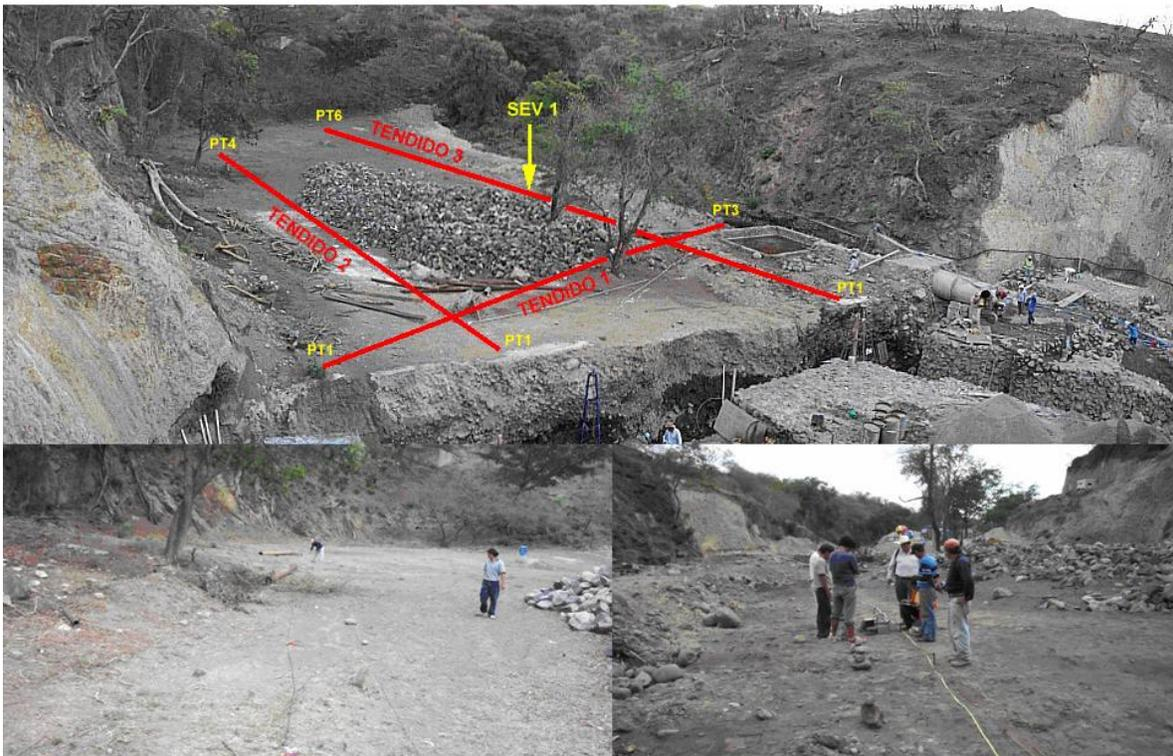
Fotografía 3. Medición de propiedades de deformación y verificación de estratigrafía con métodos de exploración geofísica: TRS, Down-Hole y SEV, en la P.A. Socavones
