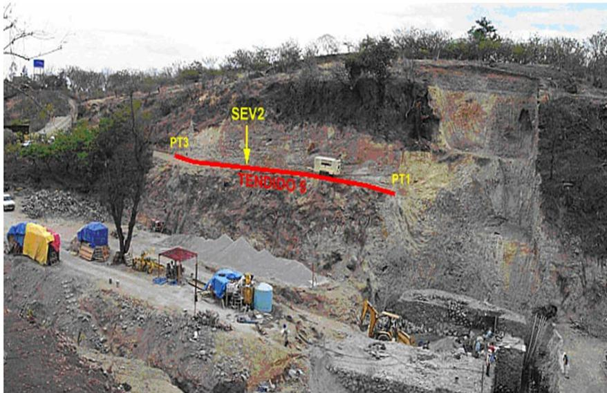
Fotografía 5. Medición de propiedades mecánicas y verificación de estratigrafía con métodos de exploración geofísica: TRS, Down-Hole y SEV, en la P.A. Socavones
