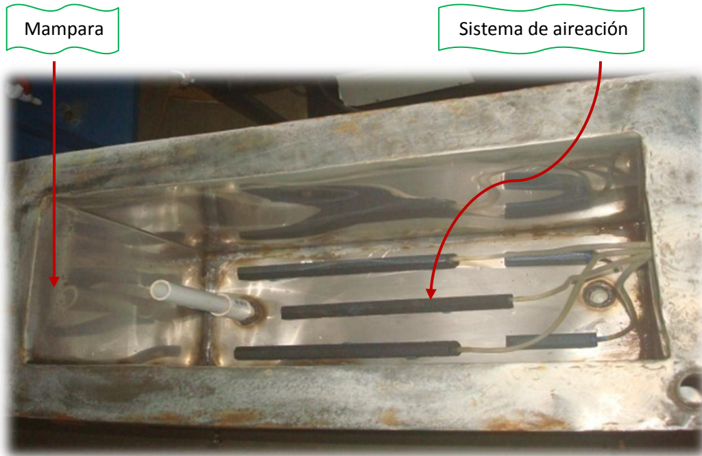
Foto 3.2 Reactor biológico y difusores de aire.
