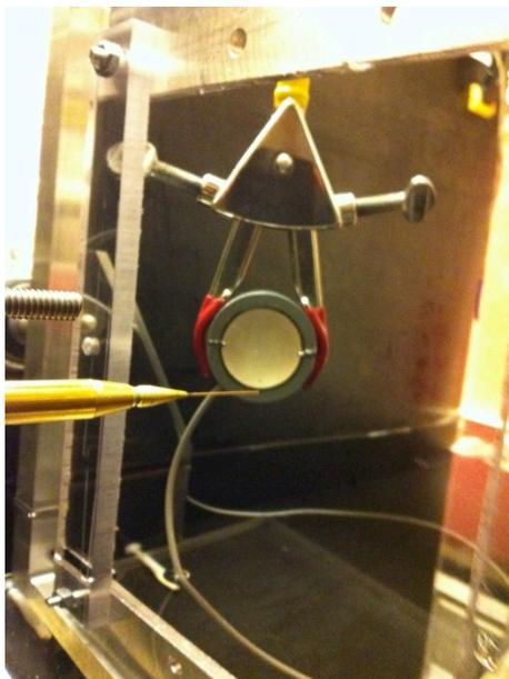
Figura 23. Imagen que muestra el transductor utilizado visto de frente y al hidrófono en primer plano, ambos se encuentran dentro del tanque sin agua y se pueden apreciar en la pared y fondo las láminas de caucho en negro.
