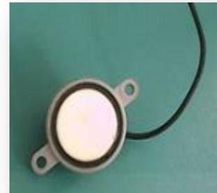
Figura 14. Transductor ultrasónico utilizado en el montaje experimental.
