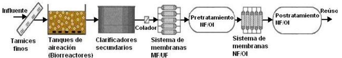
Figura 2.7 Tratamiento convencional de lodos activados con MF/UF y NF/OI.
