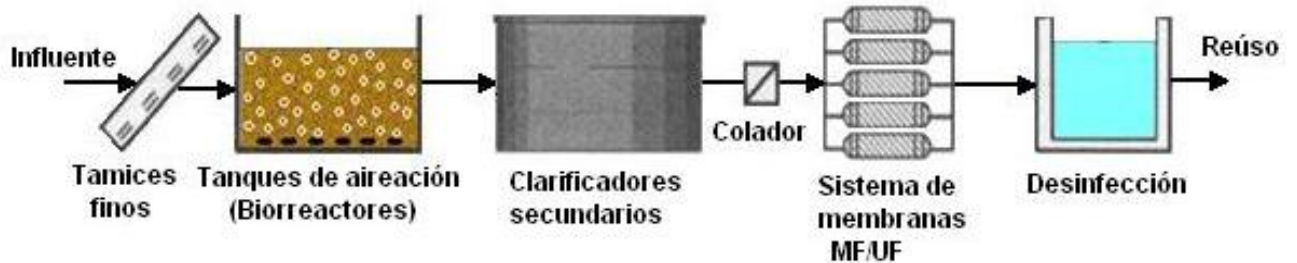
Figura 2.6 Tratamiento convencional de lodos activados con MF/UF.
