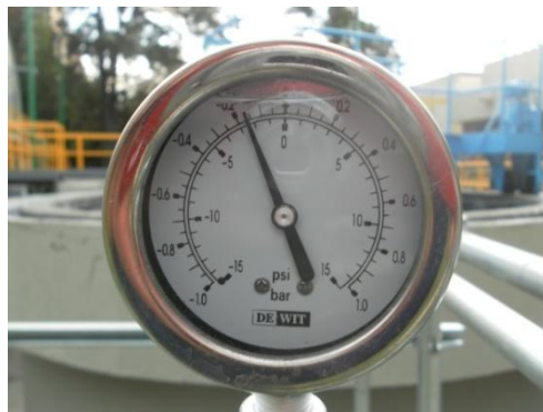
Figura AII.4 El manómetro en ciclo de operación (extracción de permeado)
