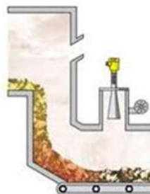
Figura 14. Enfriador de clinker.
