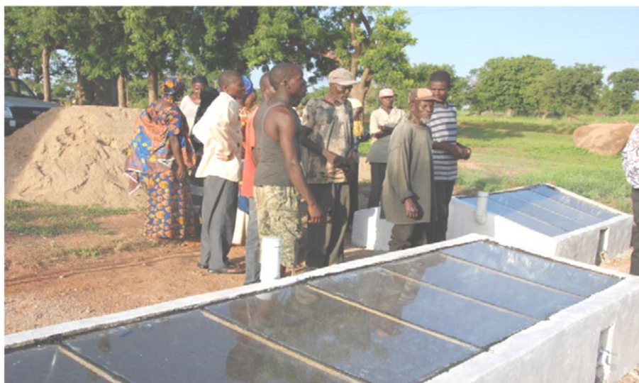
Fig. 3.10 Destiladores Solares para remoción de fluoruros en comunidades rurales de Ghana.
