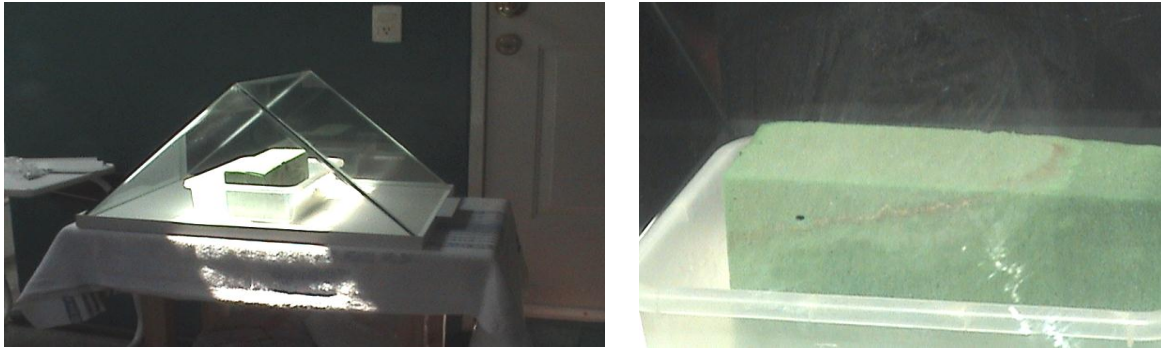
Fig.6.2 Destilador solar con un elemento sólido de absorción Material poroso: hule espuma de poliuretano
