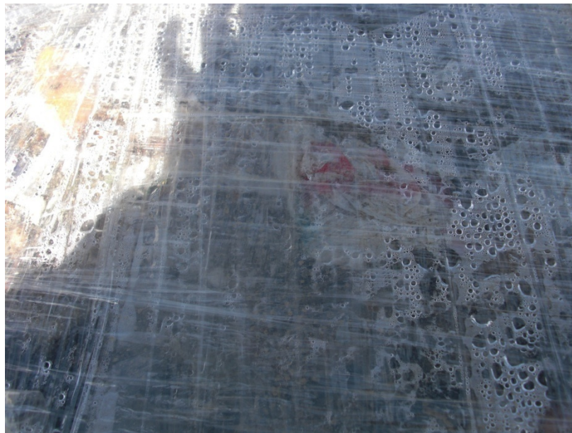
Fig. 4.2. Presencia de humedad en la superficie interna de la paca.
