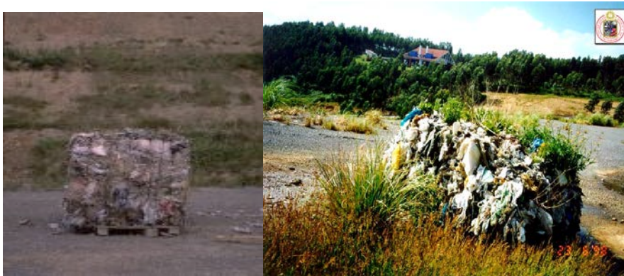
Fig. 2.1. Pacas sin impermeabilizar en el vertedero de Meruelos, Cantabria, España en 1993 y en 1998.
