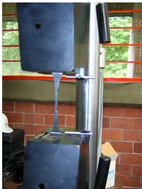
Figura 5.7 Pruebas de tensión en geomembranas con muestras tipo ASTM D 6693-07
