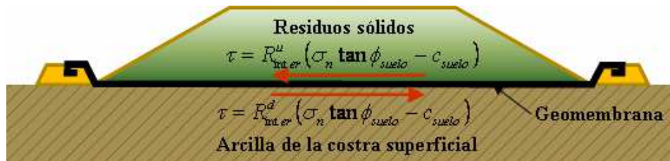
Figura 7.8 Esfuerzos cortantes en la interfaz
