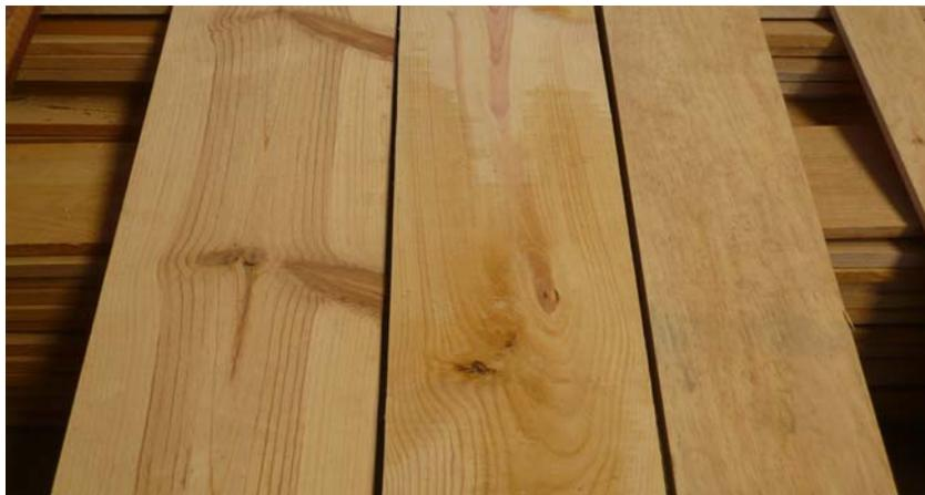
Figura 14. De izquierda a derecha: madera de pino de tercera, madera de segunda y madera de primera.
