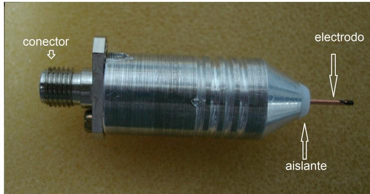
Figura 3.19 Base del electrodo con su conector.
