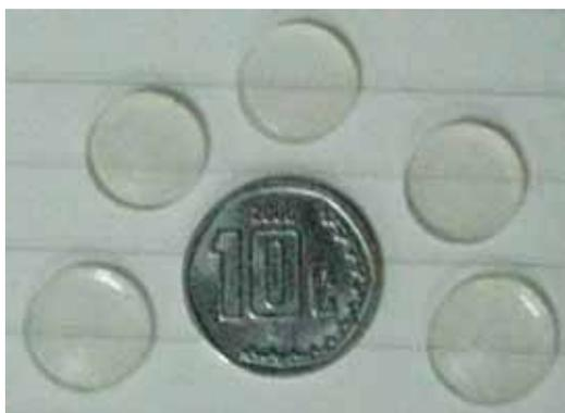
**Figura 1.4:** Fotografía de muestras sonogel puro y una referencia dimensional sobre una hoja de papel a rayas. El monolito sonogel es una pastilla cilíndrica de alta transparencia, además de contar con alta estabilidad mecánica y química
