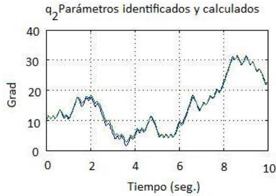
Figura 3.6: Respuesta de q_2 con parámetros simulados y calculados.
