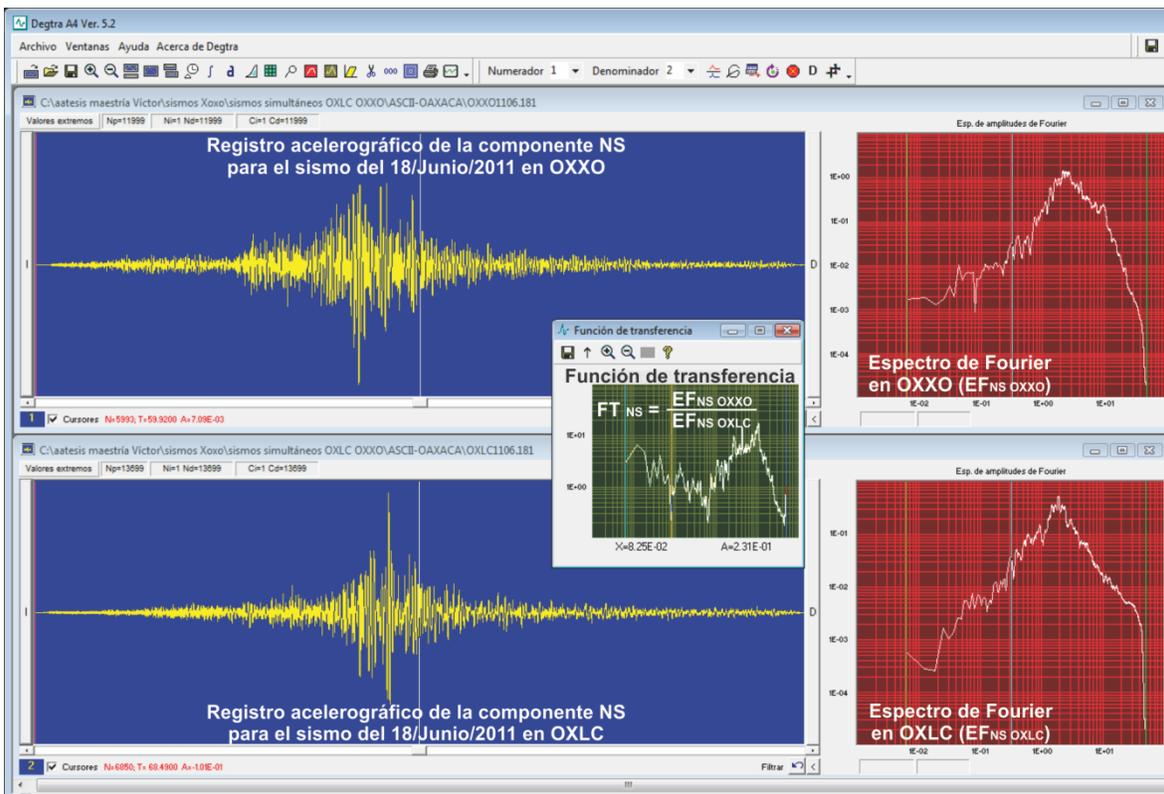
Figura IV.11. Cálculo de una FT utilizando Degtra A4
