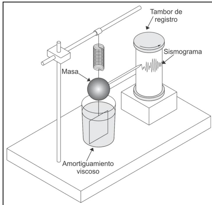
Figura II.4. Esquema de funcionamiento de un sismógrafo
