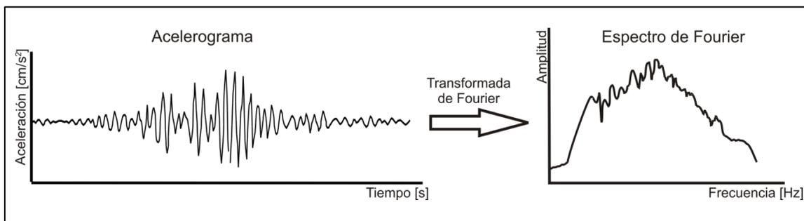
**Figura IV.4.** Cálculo de un espectro de Fourier
