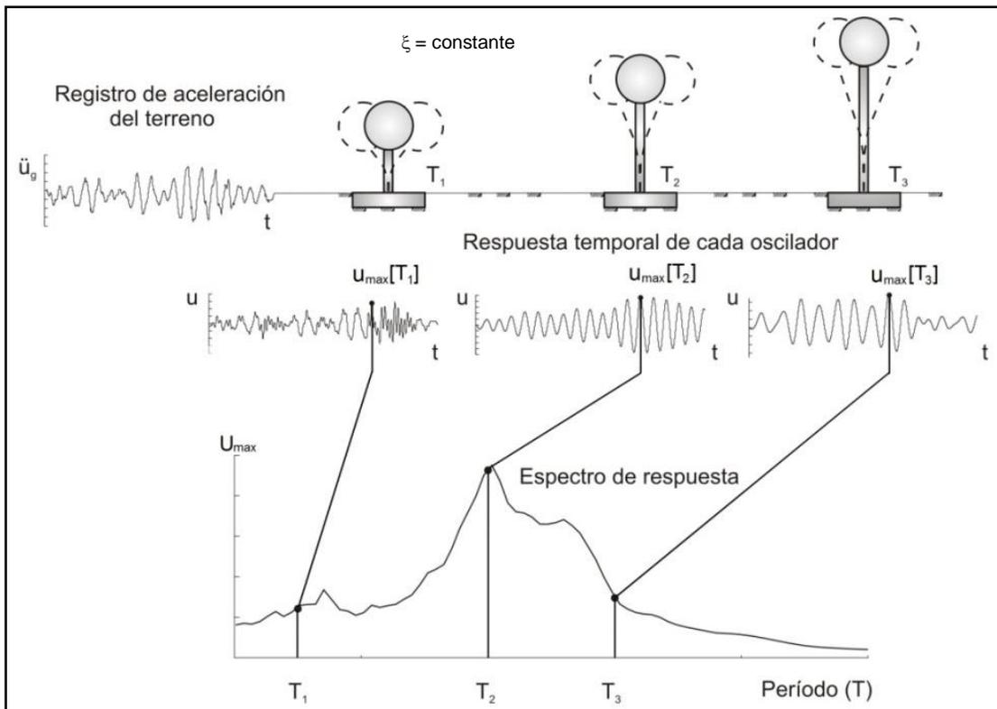
**Figura IV.3.** Construcción de un espectro de respuesta (ref. 74)
