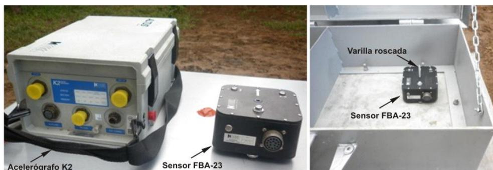
Figura III.19. Acelerógrafo Altus K2 y sensor externo FBA-23
