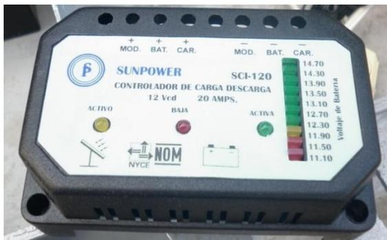
Figura III.21. Controlador de carga de celdas solares
