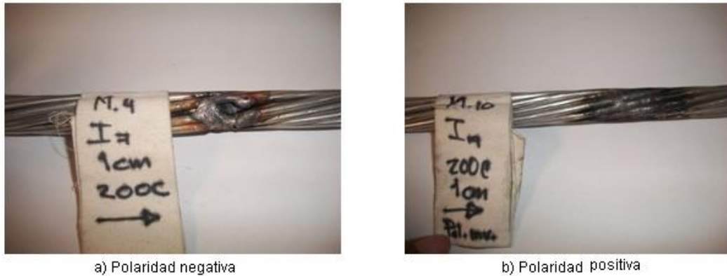
Fig. 4.5 Diferencia de los daños en el tipo de polaridad a 200C
