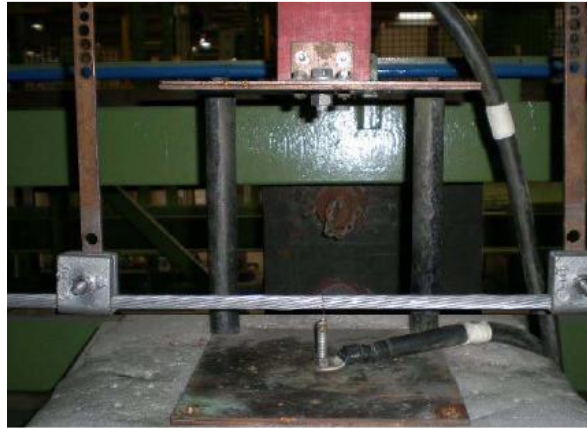
Fig. 4.2 Arreglo montaje para la prueba de Arco de Potencia
