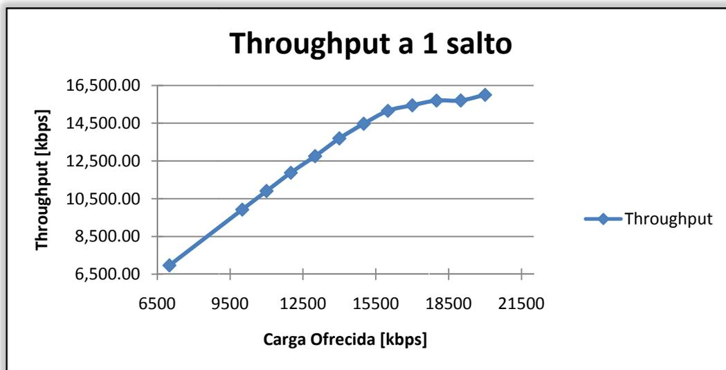
Figura 5.5: *Throughput* del sistema con un usuario transmitiendo a un salto.
