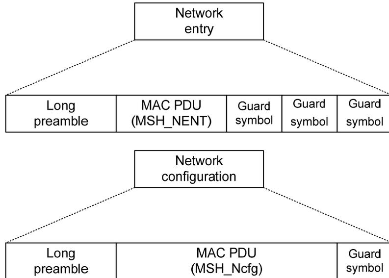
Figura 3.2: *Subframe* de Control del *frame mesh*.
