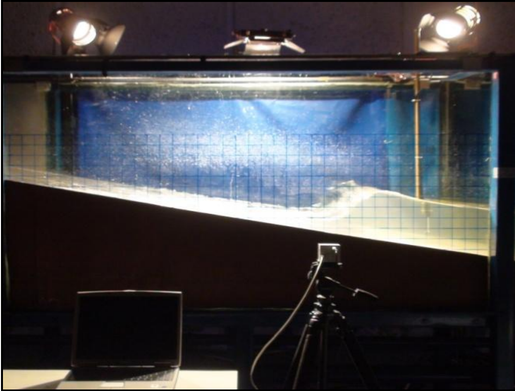
Figura 4.7 Ubicación de la instrumentación utilizada para el desarrollo de la técnica del BIV.
