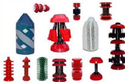
Ilustración 6.3 Diablos de poliéster, puede ser de espuma desnuda o cubierto con un material de poliuretano, puede tener un recubrimiento en espiral de poliuretano, cepillos de diversos materiales o de carburo de silicio para mejorar la capa de lavado de la pared ( http://www.indiamart.com/vp-engineers/pipeline-accessories.html ).
