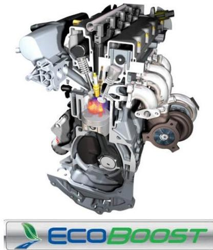
**Figura 22.-** Motor Ford EcoBoost
