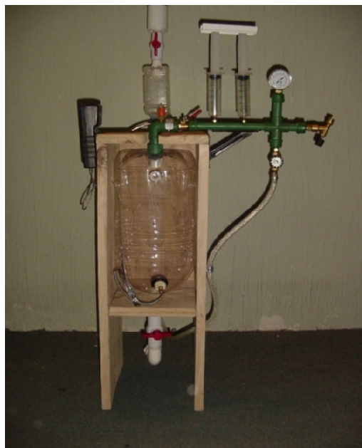
Figura 3.1. Planta piloto para pruebas del controlador.
