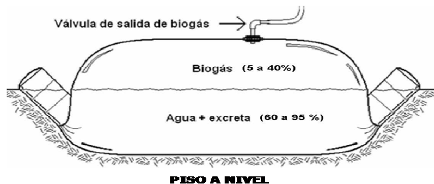
Figura A1.3. Digestor tubular de polietileno.
