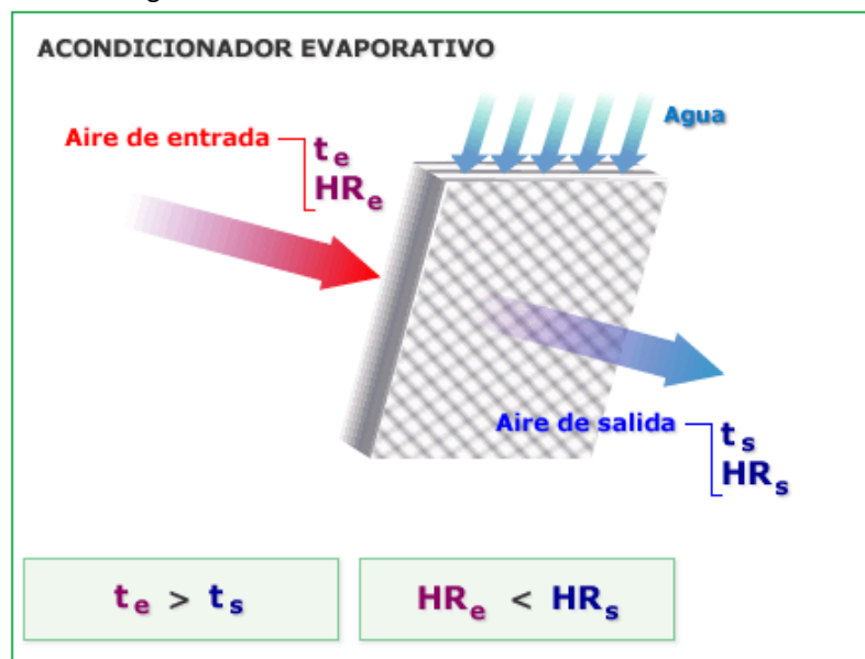
Fig. 3.15 Imagen de Superficie mojada por la que se hace pasar aire enfriándolo aumentando la humedad de este.
