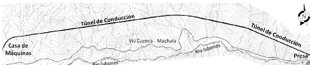
Figura 15.- Trazo del túnel en planta
