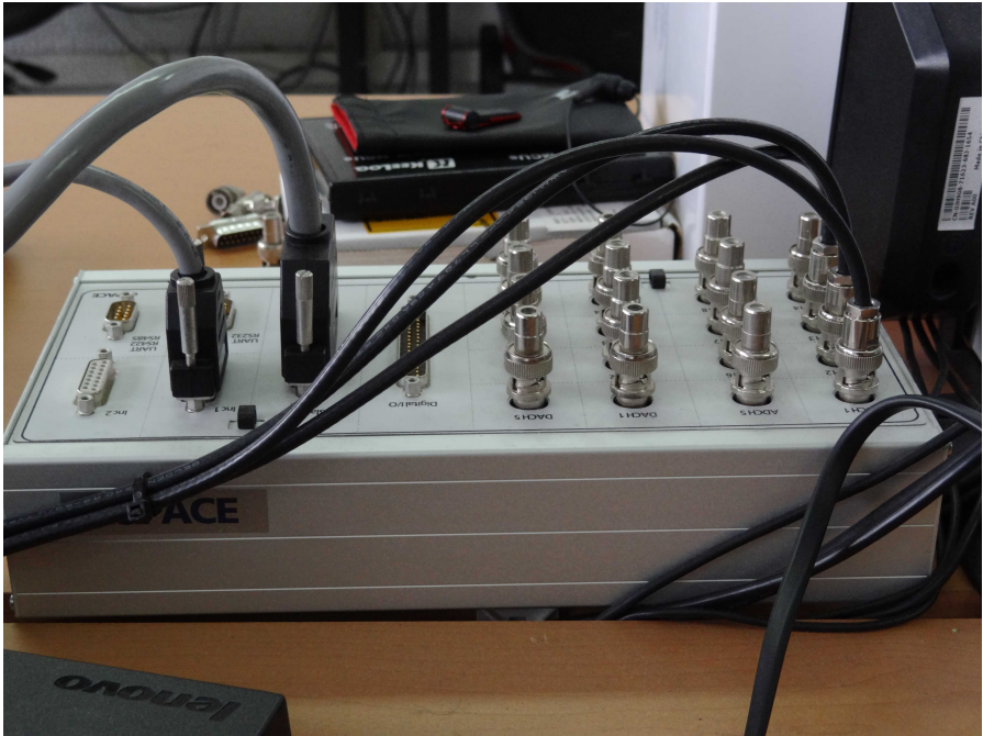
Figura A.2. Bornera de conexiones de la tarjeta de adquisición de datos
