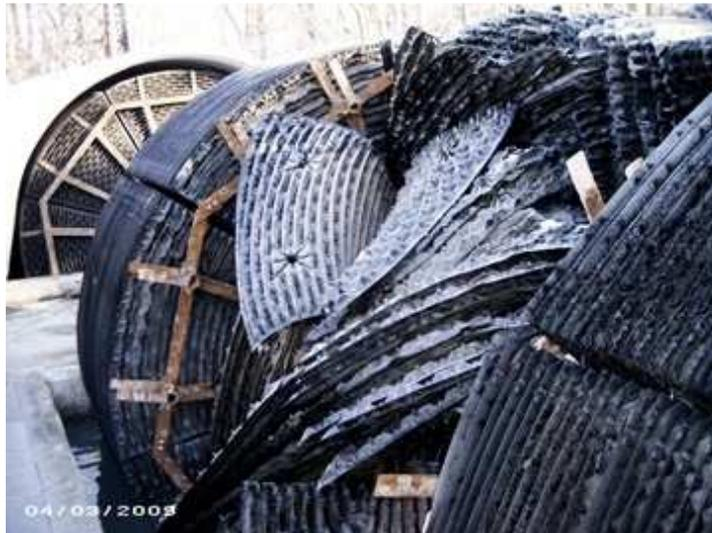
Figura 2-7. Rompimiento del material de fijación
