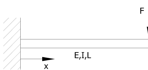
Figura 2.8: Viga en cantiléver[2]
