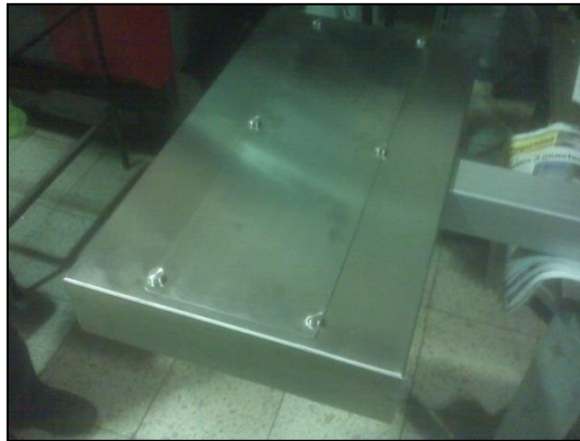
Figura 3.25. La figura muestra el soporte ya ensamblado, además de que para los soportes Tótem, se usa una tapa del lado contrario de la pantalla, esto es para proteger el sistema de control de la pantalla y para darle una buena vista.
