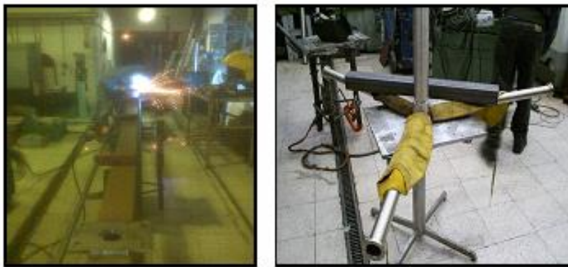
Figura 3.28. Algunos ejemplos de cómo se fabricaron los soportes, fotografías tomadas dentro del taller de producción. Del lado izquierdo muestra el ensamble del Soporte Larguero. Del lado derecho se muestra el ensamble del Soporte Kiosco.
