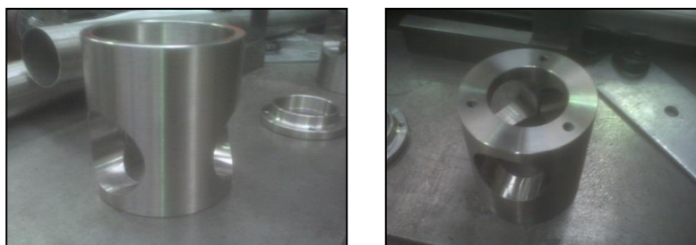
Figura 3.12. Brida. Fabricada en acero inoxidable tipo A 304.
