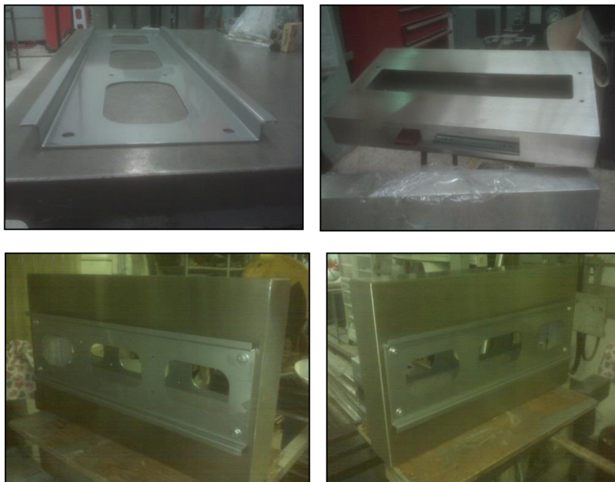
Figura 3.24. La figura muestra la caja usada para los soportes Tótem y para soportes dobles a techo. El motivo de que en su interior sea hueco, es debido a que dentro se coloca el control de las pantallas de información.
