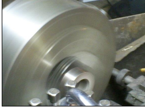
Figura 3.13. La figura muestra parte de la fabricación de la brida en un torno.
