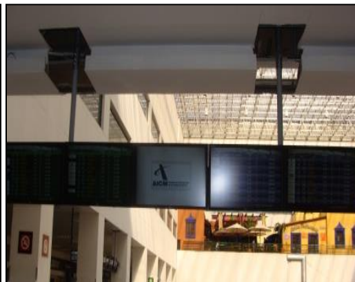
Figura 2.3. Soporte en línea sencillo para 5 pantallas. Archivo general de DIMITEC.
