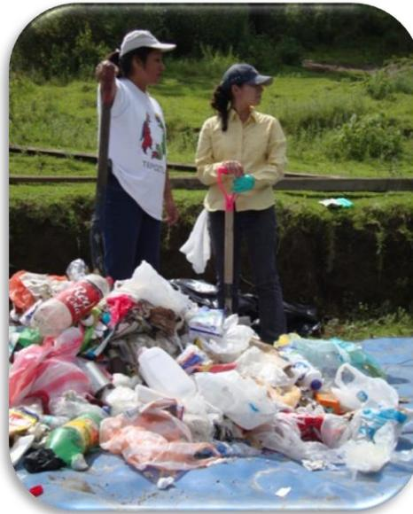
**Figura 3.23** Homogenización de la muestra.
