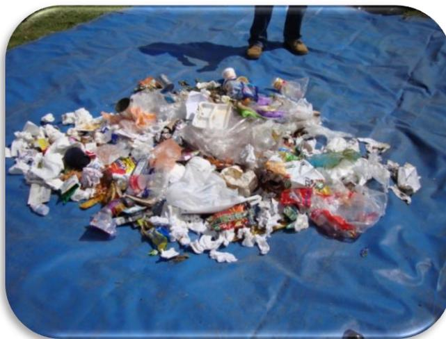
**Figura 5.22** Residuos utilizados en el método de cuarteo.
