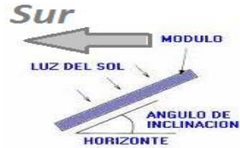
Figura 3.4.- Posición del panel solar.
