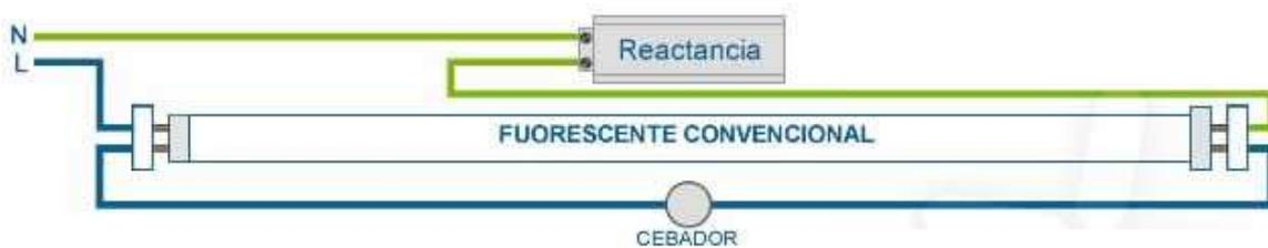
Figura 42 Conexión de tubos fluorescentes [7]
