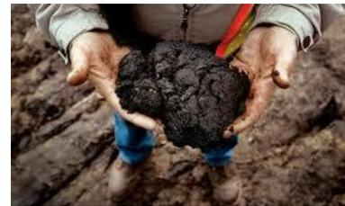
Figura 1.6- Muestra de Arenas Bituminosas.
