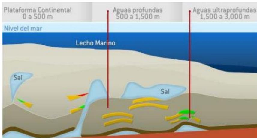
Figura 1.9- Definición gráfica de aguas profundas y ultraprofundas.
