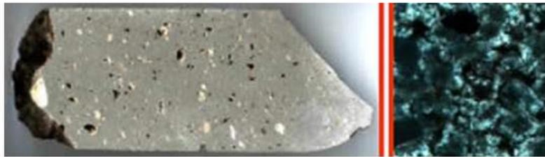
Figura 1.14- Núcleo y corte de una Caliza Oolítica
