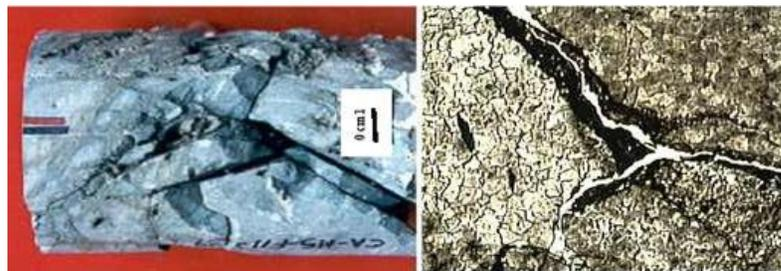
Figura 1.15-Núcleo y corte de una Caliza fracturada
