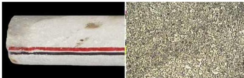
Figura 1.10- Núcleo y corte de una Arenisca .
