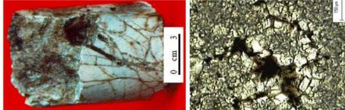
Figura 1.13- Núcleo y corte de una Caliza cristalina
