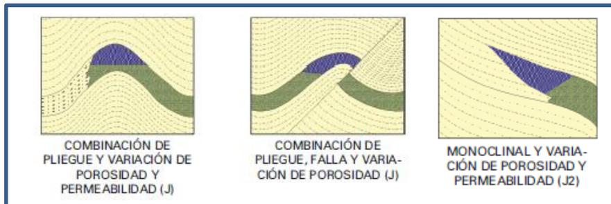
Figura 1.18.- Secciones transversales de Ejemplos de Trampas Combinadas
