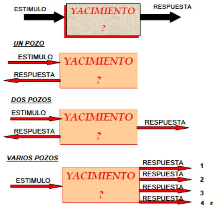
Figura 3.3.- Información de entrada y salida del sistema en pruebas de variación de presión.
