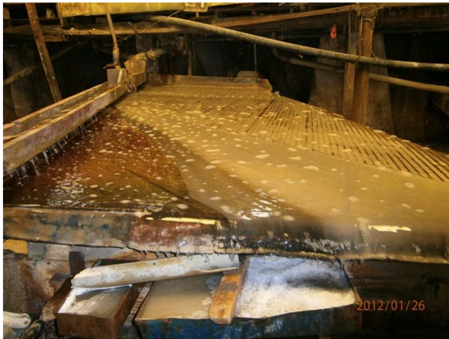
Figura 1.1. Mesas vibratorias usadas para el reprocesado de los jales (colas) de las minas estanníferas de Catavi, en Llallagua.
