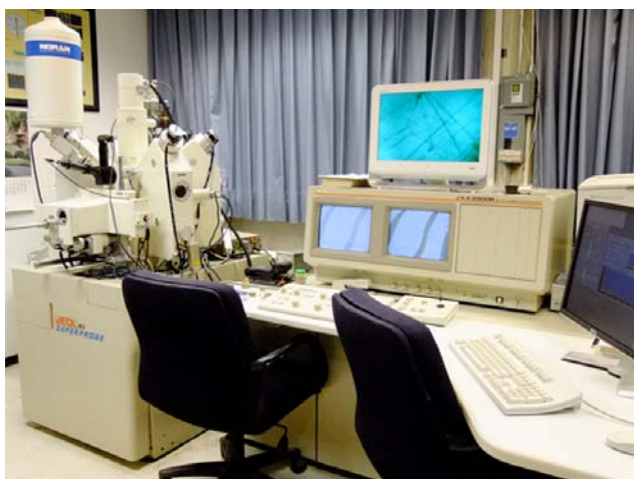
Fig. 2.7. Microscopio electrónico de barrido JEOL JXA8900-R, Laboratorio Universitario de Petrología, Instituto de Geofísica, UNAM.
