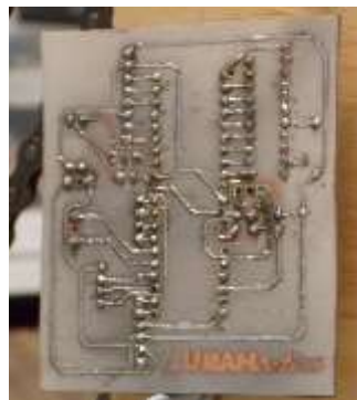
Imagen 4.4. Prototipo de la tarjeta controladora de motores.
