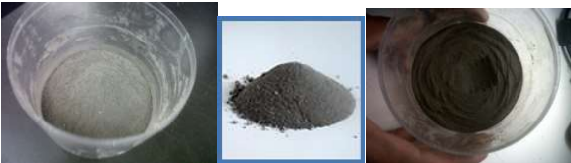
Imagen 3.5. Simulante de suelo lunar JSC-1A y pruebas de características.
