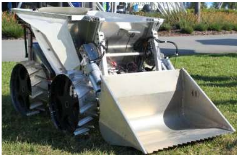
Imagen 3.20. Robot de excavación de la Universidad de West Virginia
