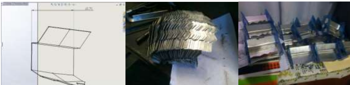
Imagen 4.20. Proceso del desarrollo del prototipo de cangilón.
