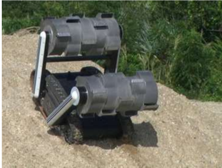
Imagen 5.41. Mecanismo de cilindro giratorio.
