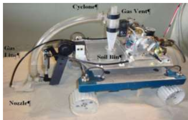
Imagen 3.16. Excavadora Lunar Neumática, fase de pruebas dentro de cámara de vacío (Zacny et al. 2008b).
