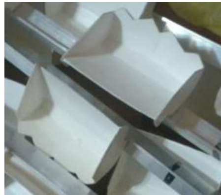
Imagen5.49. Cangilones manufacturados en fibra de vidrio.
