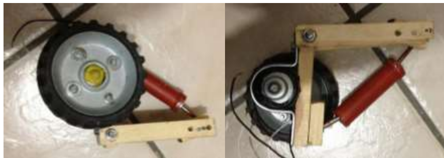
Imagen 4.15. Imagen de las llantas y la suspensión de prueba.
