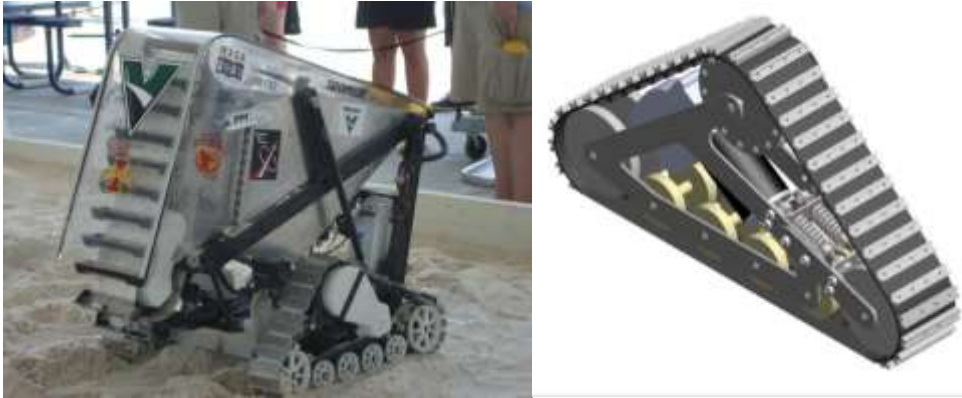
Imagen 3.24. Robot diseñador por Iowa State University (izquierda), Diseño de tracción por orugas (derecha).
