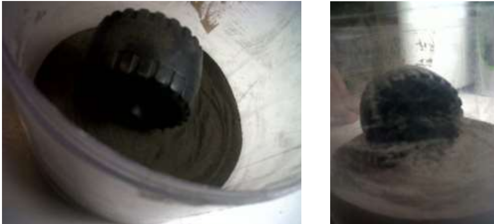
Imagen 4.5. Prueba de llantas en el simulante lunar.
