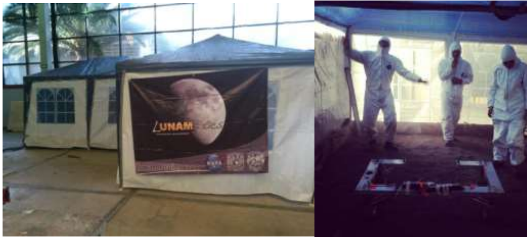
Imagen 6.4. Lunarena realizada (Izq.) y pruebas de tracción en el simulante (Der.).
