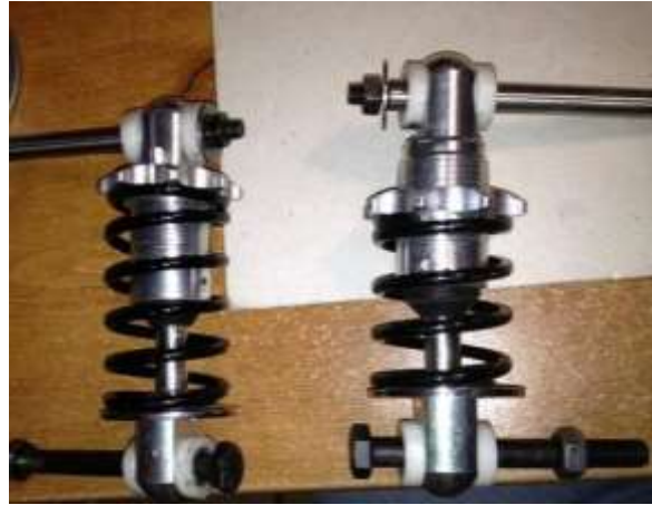
Imagen5.29. Comparación de resortes usados en la suspensión.
