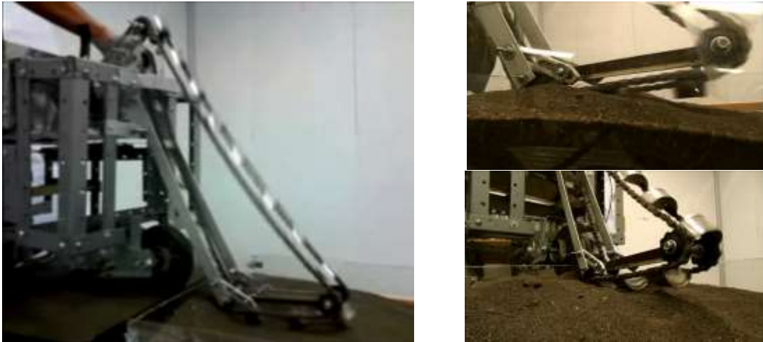
Imagen 4.6. Pruebas realizadas al método de excavación con cadena de cangilones
