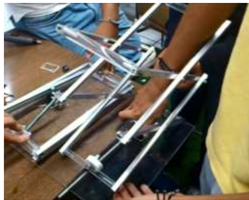
Imagen 4.7. Prueba del sistema de elevadores de tijera
