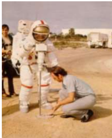
Imagen 3.11. Astronauta del Apolo practicando en el empleo del Apolo Lunar Surface Drill (Imagen: NASA).
