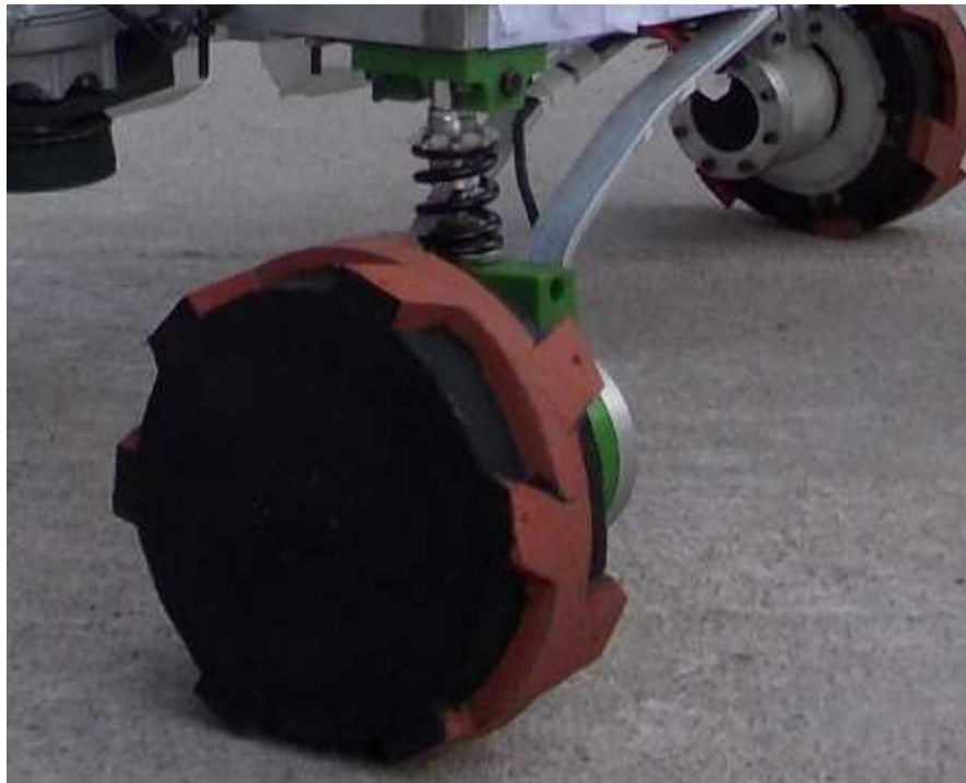
Imagen5.30. Suspensión acoplada al rover.
