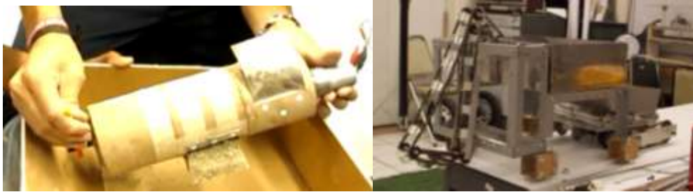
Imagen5.42. Prototipos de la excavadora de cilindro giratorio (izq.) y excavadora de cangilones (der.).
