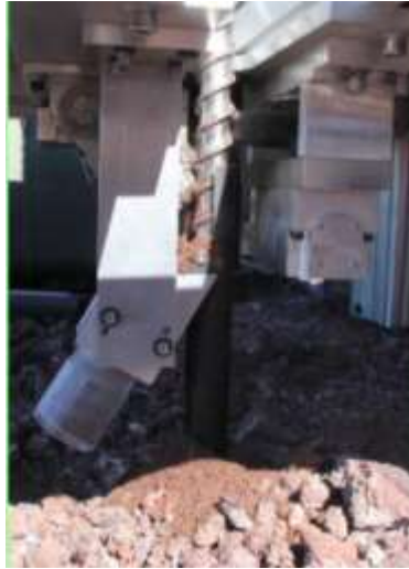
Imagen 3.15. El Moonbreaker permite el almacenamiento de regolito o el análisis directo del mismo
