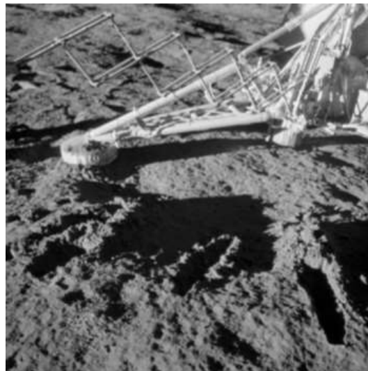
Imagen 3.10. Fotografía del cangilón del Surveyor 3 tomada por astronautas del Apolo 12.
