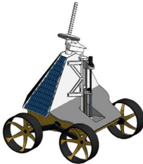
Imagen 1.14. Rover lunar Astrobotic con taladro de perforación Moonbreaker de Honeybee Robotics (Honeybee Robotics, 2012).
