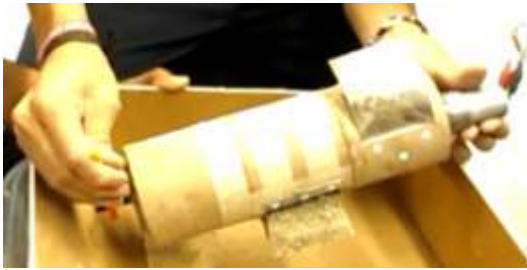
Imagen 4.14. Prueba del método de excavación “Cris” con dos materiales cartón (Izq.) PVC (Der).
