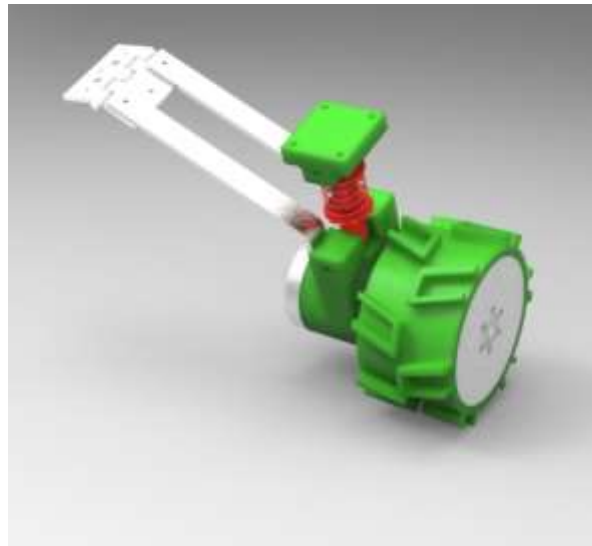
Imagen5.28. Diseño de la suspensión.
