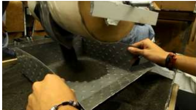
Imagen 4.14. Prueba del método de excavación “Cris” con dos materiales cartón (Izq.) PVC (Der).
