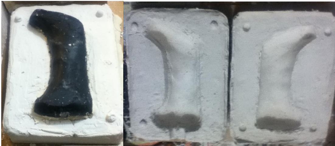
Figura 9.8 Muestra del desarrollo del molde para trabajar la espuma de poliuretano.
