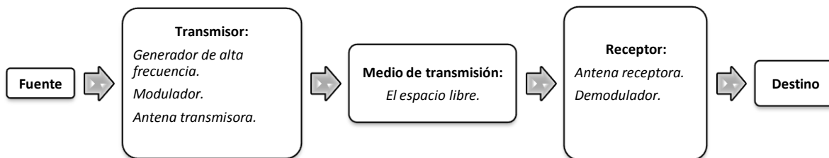
Fig. 1.1- Esquema convencional de un Sistema de Radiocomunicaciones.
