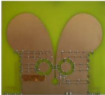
Fig.1.51 - Antena reconfigurable basada en la estructura de una antena Vivaldi.
