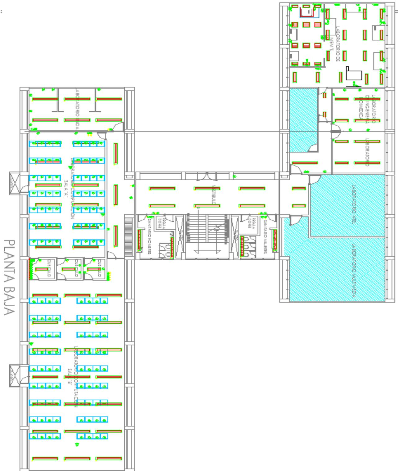
**Fig. 9 Ubicación de luminarias y contactos de la planta baja**
