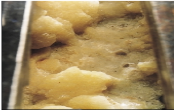
Figura 2.18. Eliminación de incrustaciones de carbonato de calcio con chorros de agua.
