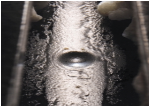
Figura 2.19. Tubería sometida a limpieza con abrasivos de partículas de vidrio.
