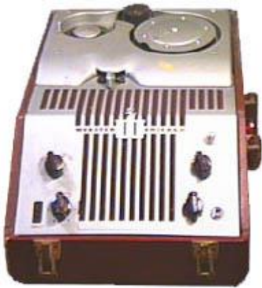
Figura 4-6 Grabador de alambre de acero Webster modelo 80
