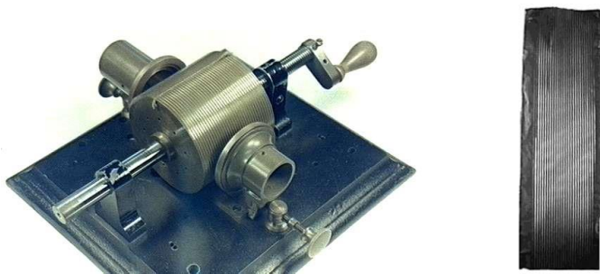
Figura 2-3 a) Figura del primer fonógrafo de Edison b) Grabación sobre un cilindro de lámina hecha con un fonógrafo
