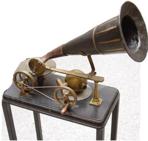
Figura 4 Imagen del primer Gramófono de Berliner
