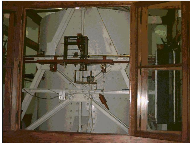
Figura 3.1 Sismógrafo horizontal Wiechert de 17,000 kilos 1910 (ref. 53)
