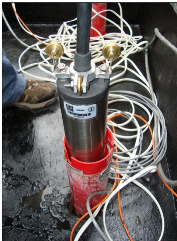
Figura 2.9 Colocación de sensores de pozo (ref. 48)
