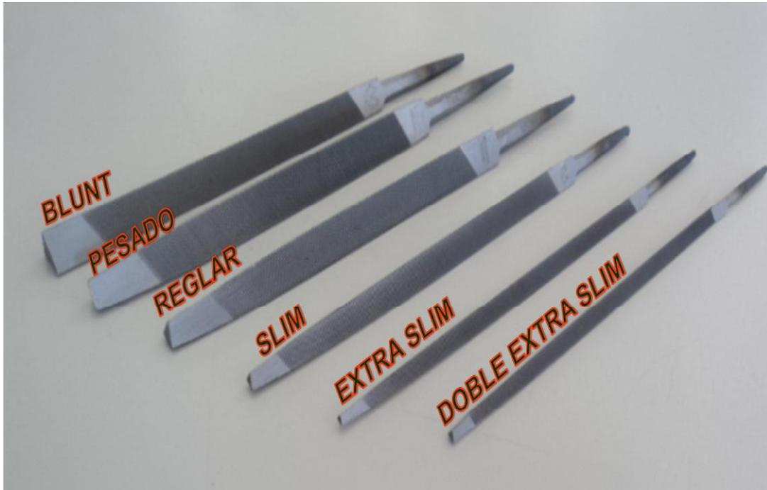
Figura 2.4 Tipos de Limas Triangulares
