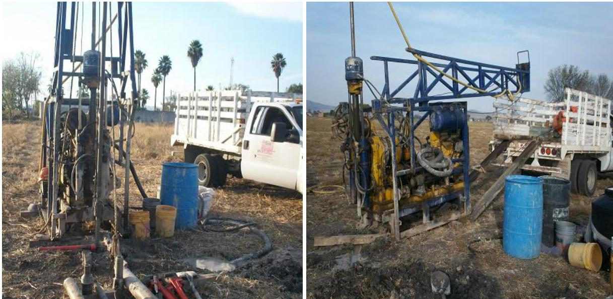
**Figura 3.2:** Sonda Longyear-34, utilizada para la perforación de los sondeos 1,2 y3.
