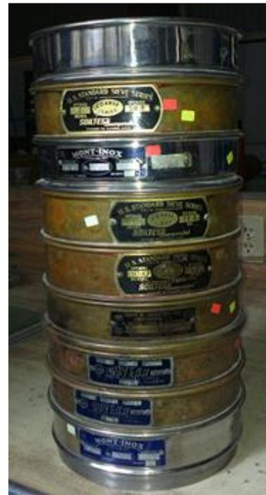
**Figura 3.17:** Tamices utilizados para la prueba de granulometría.
