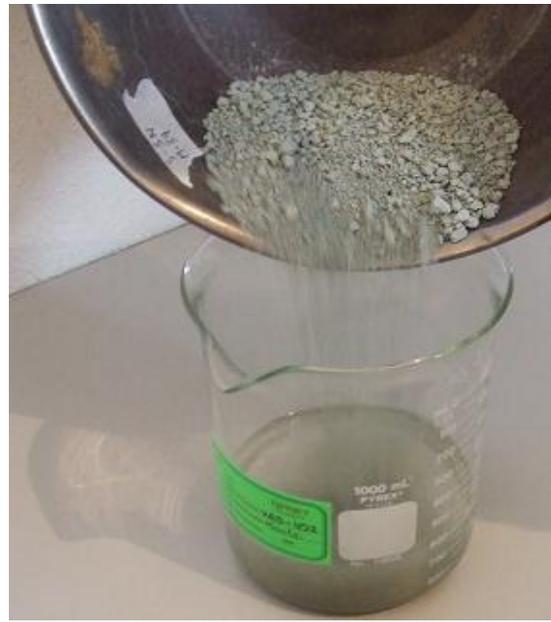
**Figura 3.16:** Mezcla de Hexametáfosfato de sodio, S-1.
