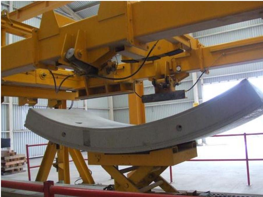
**Figura 6.1:** *Dovela (revestimiento primario del túnel), Planta de Dovelas, TEO.*
