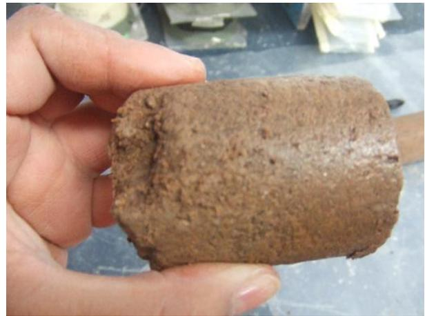
**Figura 3.6:** Limo arenoso, del sondeo 2.
