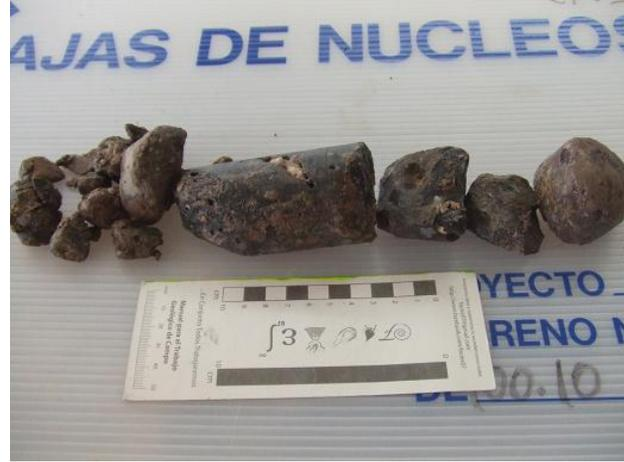
**Figura 3.12:** Fragmentos de basalto de hasta 10 cm de longitud, S-2.
