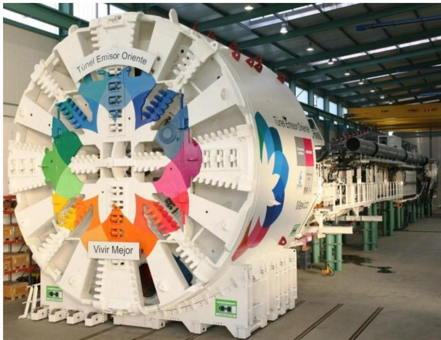
**Figura 1.1:** Máquina tuneladora E.P.B (Earth Pressure Balanced), diámetro 8.74 m, utilizada en el Túnel Emisor Oriente.
