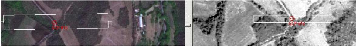
Es recomendable que se pruebe en diferentes zonas de la imagen, si todos los puntos no se alejan más de una unidad según el detalle de apreciación, se pueden dar por bueno los puntos de control para la ortorrectificación.
