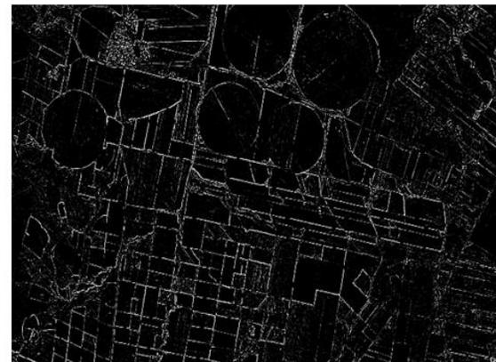
Convolución (*Convolve*). El filtrado por Convolución es el proceso de promediar pequeños conjuntos de píxeles a través de una imagen. Este filtrado se usa para cambiar las características de la frecuencia espacial de una imagen.
