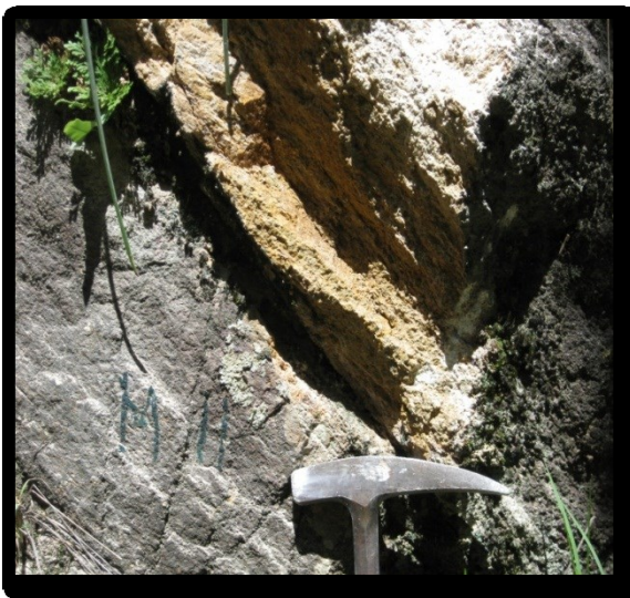
Figura 4.40. Muestra HM-11. Tamaño de grano de arena media, empaque cerrado, cuarzo 80% matriz menor al 15%. Se ubica en el arroyo al norte de Tres Caminos.
