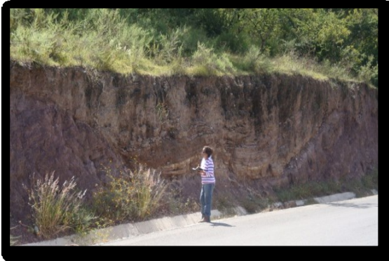
Figura 2.12. Contacto entre material rojo (toba del Cenozoico) parte superior y metamórfico (Complejo Acatlán del Paleozoico) parte inferior, ubicado al oeste del poblado de Cualac Guerrero.
