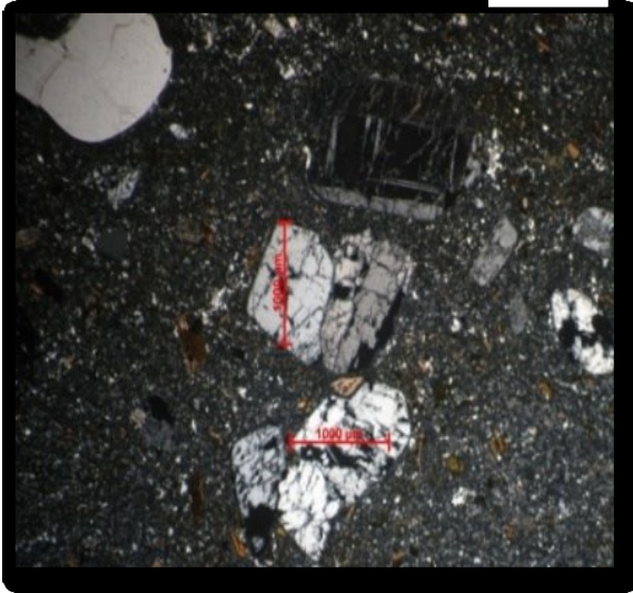
Figura 4.15. Muestra HM-5. Presenta cuarzo 20%, plagioclasas 40%, feldespato 20% y micas 20%. Se ubica en la localidad de La Carretera (CCC).
