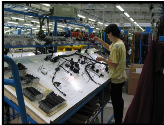
Figura 4.19 Ensamble de un arnés en tablero [78]
